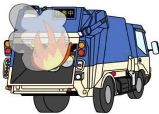
一般ごみと一緒に出されたリチウムイオンバッテリーが、ごみ収集車の中で、押しつぶされて出火した。
